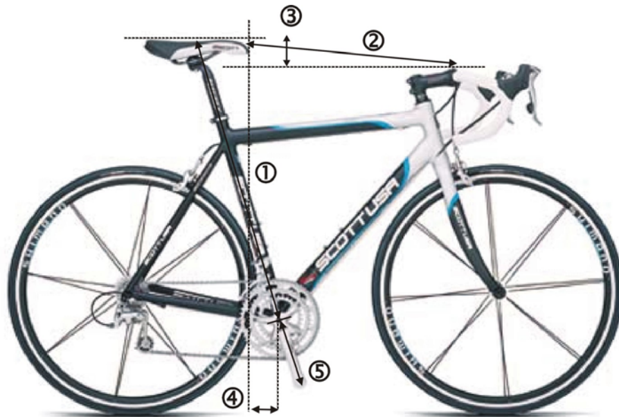
Abb. 3.13: Sitzpositionsrelevante Größen am Rennrad; 1: Sitzhöhe, 2: Sitzlänge, 3: Sattelüberhöhung, 4: Nachsitz, 5: Kurbellänge (modifiziert nach SCHMIDT 2000)
